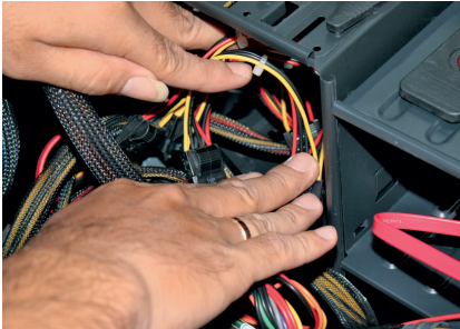
12. Merapikan kabel untuk sirkulasi bagus.
