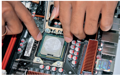
4. Perhatikan dua cekungan pada sisi processor.
