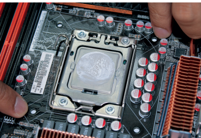
6. Perhatikan 4 lubang dudukan pada motherboard.
