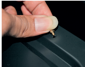
8. Pemasangan spacer cukup dengan tangan.
