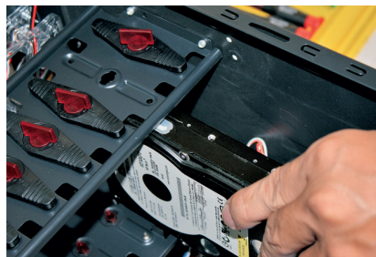
4. Masukkan ke rail pada casing.
