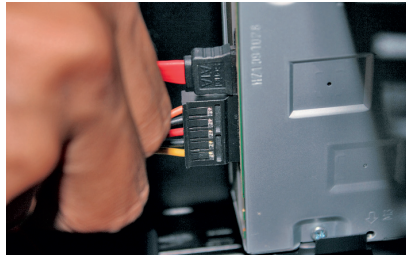
6. Pasang konektor power SATA pada ODD.
