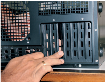
5. Potong/patahkan plat pada slot PCI.
