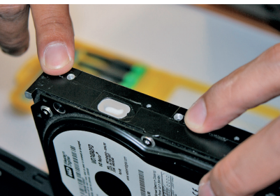
3. Lubang dudukan pada sisi harddisk.
