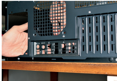
4. Pasang I/O shield pada backpanel casing.
