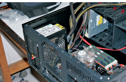
1. Tempatkan PSU dalam casing.
