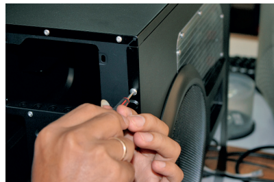
1. Buka side case dengan menggunakan obeng.
