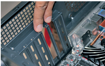
3. Potong atau patahkan plat slot PCI.
