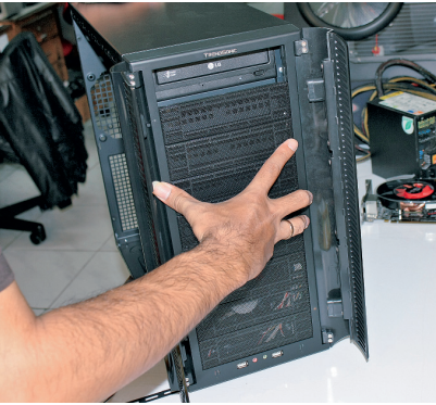
6. Tekan ke dalam untuk memasang front panel.
