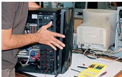
3. Buka front panel untuk memudahkan.
